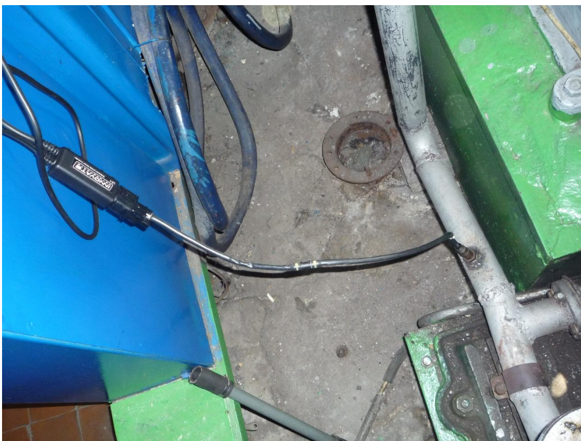
Рисунок 3.14 – Широколінійний контролер LC-1 вмонтований у випускnu систему
