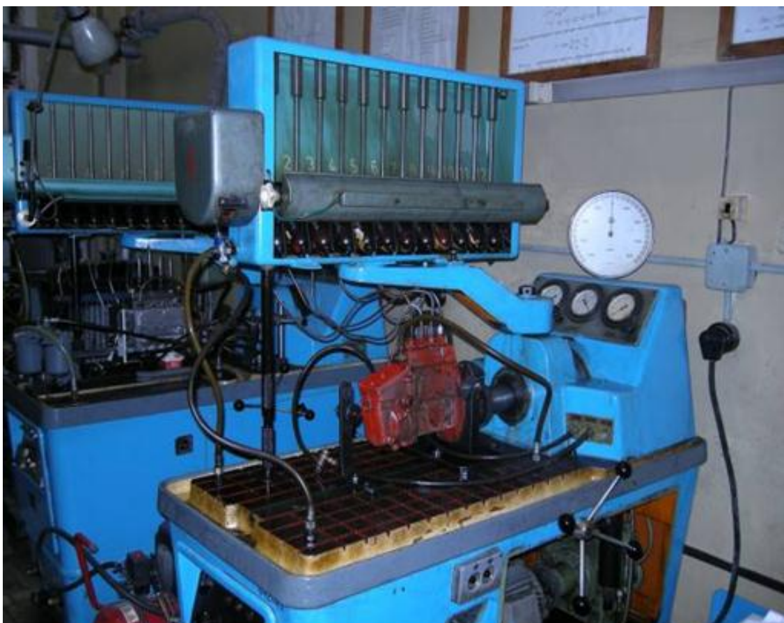
Рисунок 3.4 – Насос 4УТНМ на стенді Motorpal NC-104
