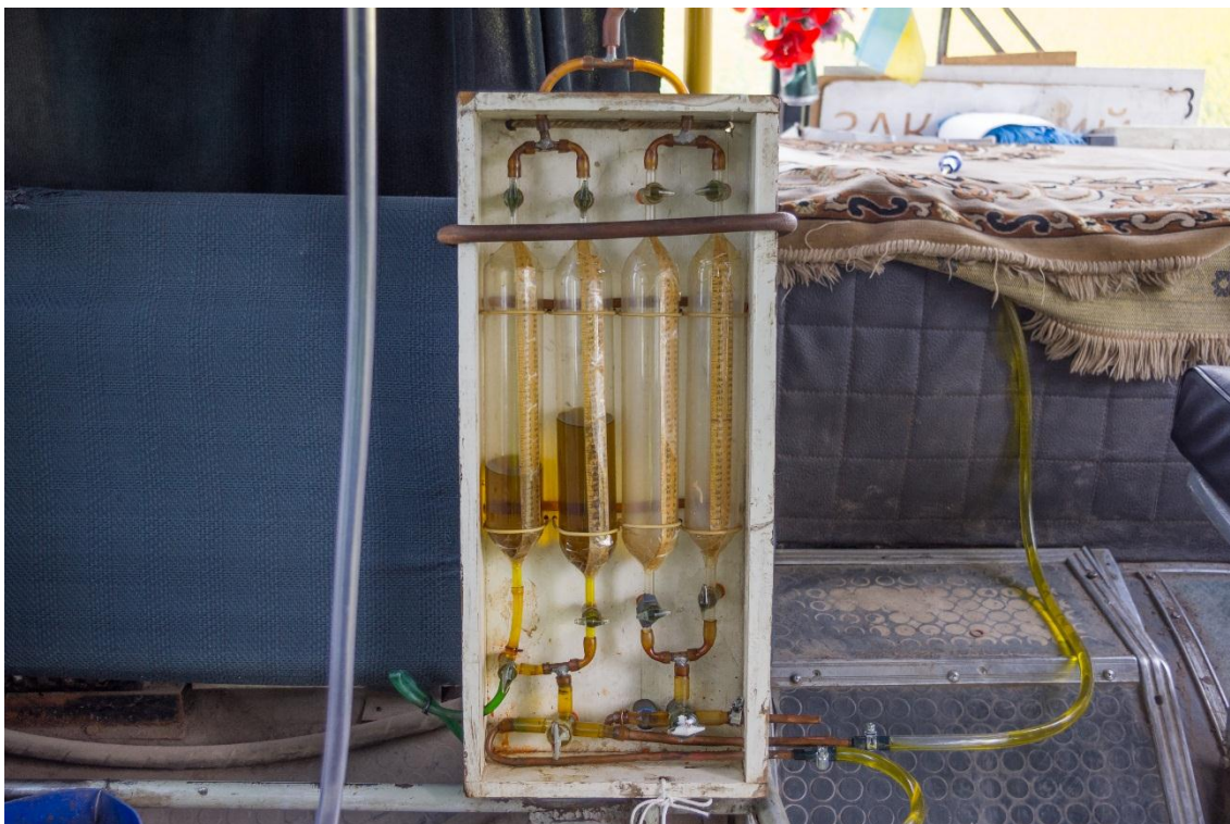
Рисунок 3.17 – Об'ємний витратомір, підключений до системи живлення дизеля
