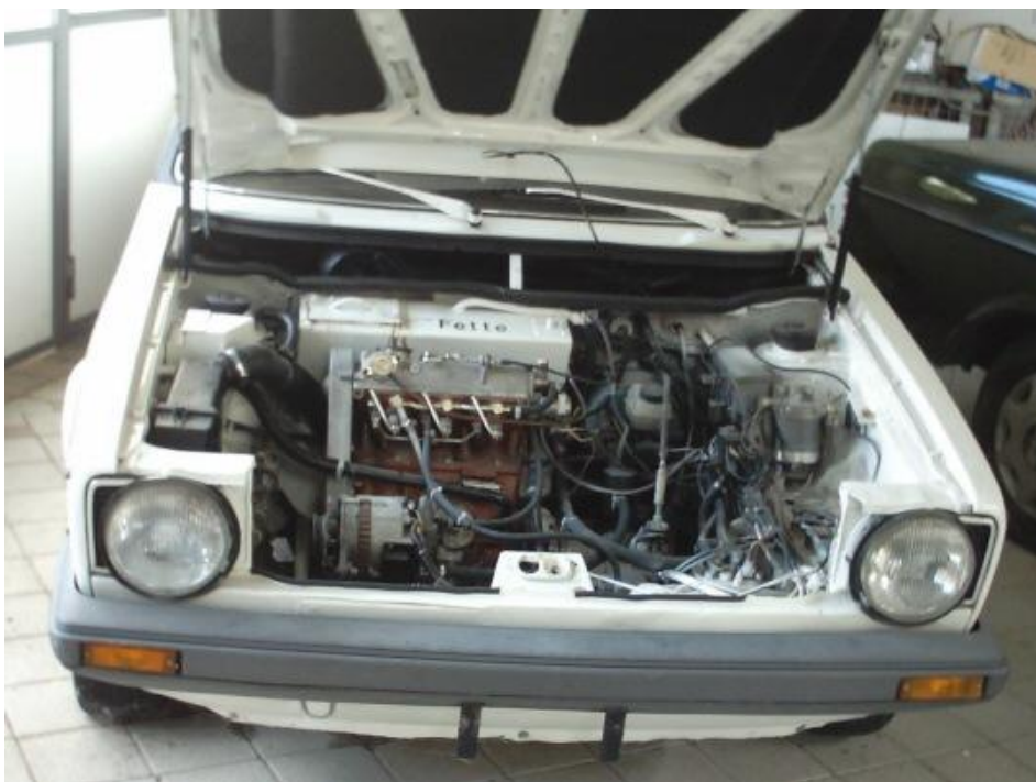
Рисунок 1.7 – Двигун Elsbett ELKO 3.82.92T на автомобілі Volkswagen Golf
