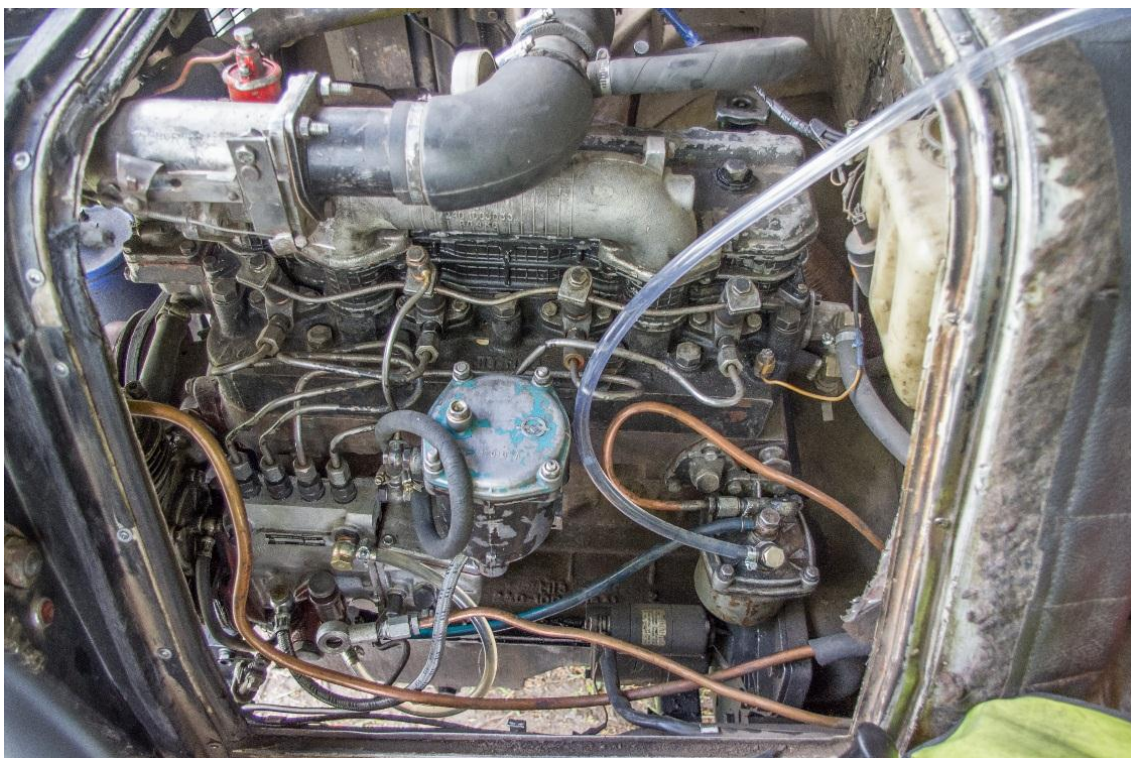
Рисунок 3.3 – Дизель 4C11,0/12,5 (Д-241), встановлений на автобус ПАЗ-32054
