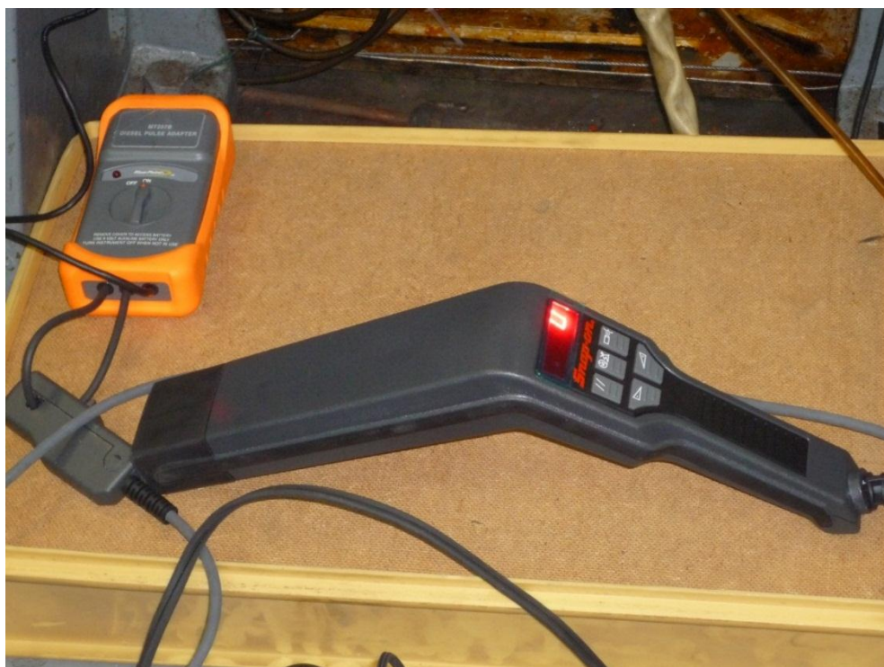
Рисунок 3.15 – Стробоскоп SNAP-ON MT2261 та приставка SNAP-ON MT 257A
